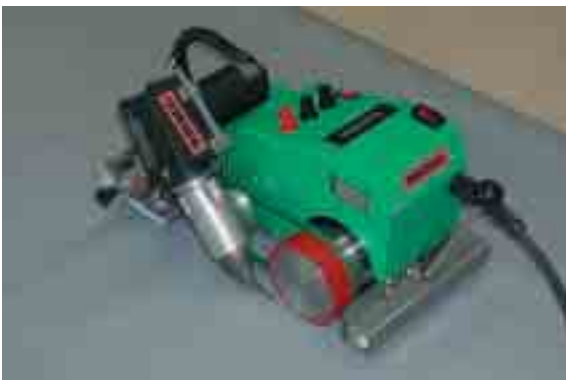
Uniplan usada para soldar a solapa una lona de camión. Velocidad de soldadura 7m/min. (23 pies/min).
