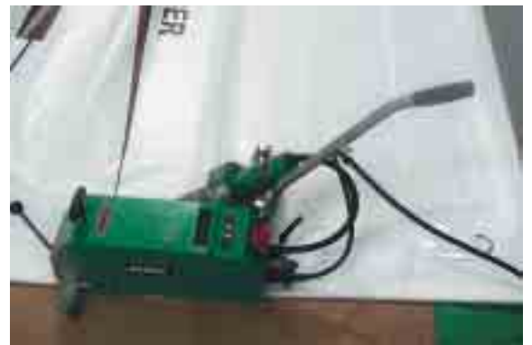
Unimat, soldando sobre una lona un dobladillo de 40mm. Velocidad de soldadura 8.5m/min. (28p/min.)
