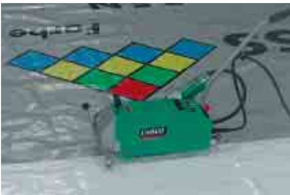
Soldando a solapa 20mm una lona de camión, usando La Unimat. Velocidad de soldadura 12m/min. (40p/min.)
