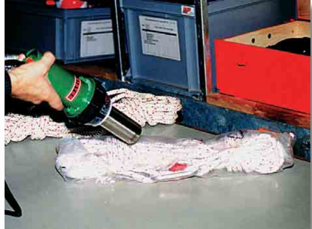
Embalando por retracción cuerdas de seguridad con el soplante de aire caliente ELECTRÓN.
